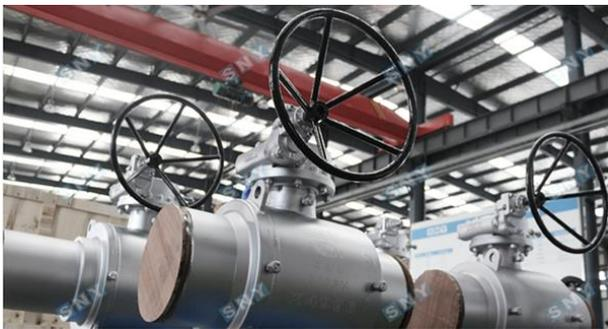
该项目圣泰中标的产品为 16 台全焊接固定球阀，两端焊接符合 API 5L 标准的袖管，最大公称通径 12 英 (DN300)，最大设计压力 10Mpa (Class 600)，全通径设计符合 API 6D 标准，防火设计符合 API 6FA 标准，并具有上下游单活塞阀座 (DBB)，双重密封设计 (PMSS)，防静电及带锁紧装置等功能。所有产品严格按照订单要求和标准执行，试验持续时间超过 API 6D 标准规定时间一倍，经第三方权威检测机构现场试验见证，各项性能均满足相关规定，一次性通过验收并于近日顺利发货。
