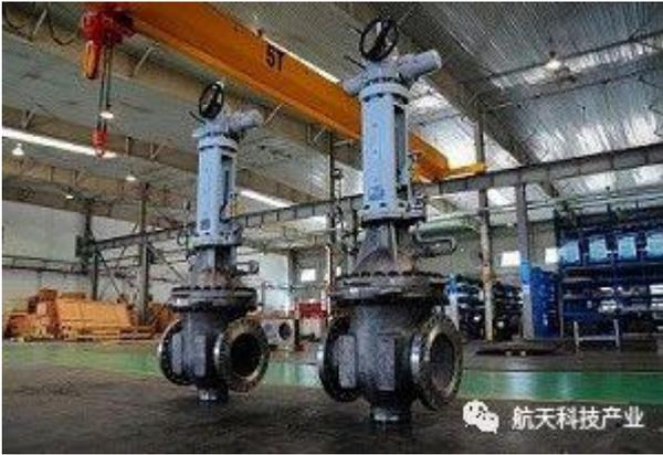
据悉，双楔式闸阀是甲醇制烯烃（MTO）、丙烷脱氢装置的核心工艺阀门，对于保证装置连续运行具有至关重要的作用，其应用环境耦合了高温、高腐蚀、高磨损和动作频次极高等多种工况，研制难度非常大。
